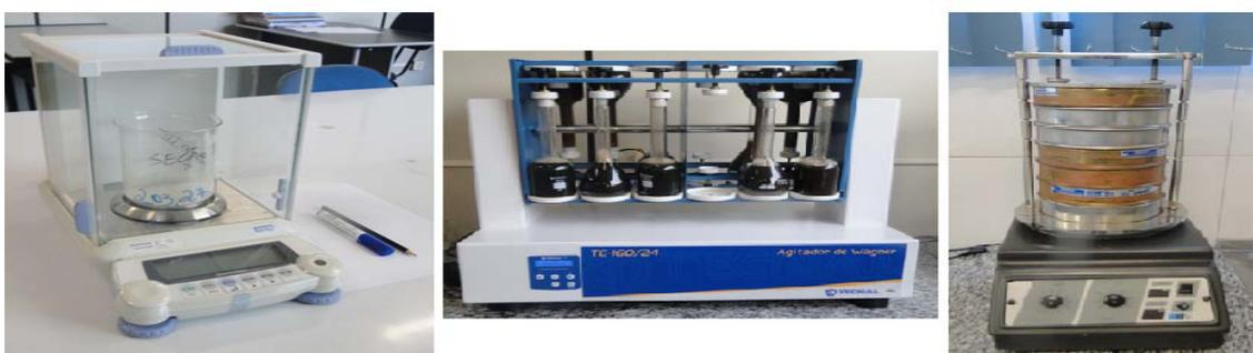
**Figura 2.** Balança de precisão, Agitador de Wagner e Agitador de peneiras.
