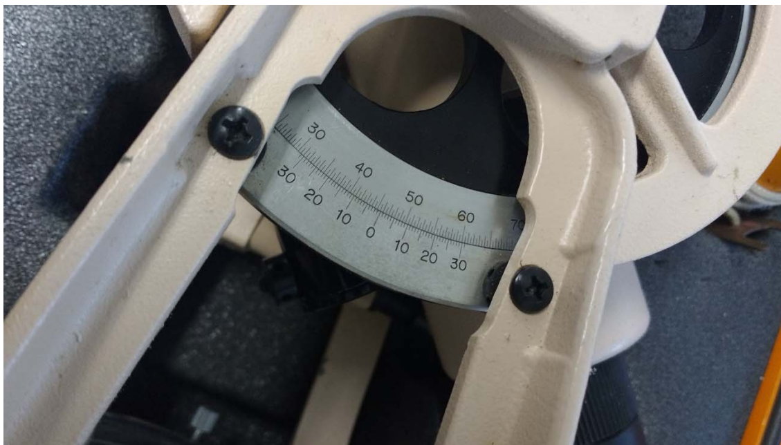
Figura 2. O Limbo e as especificações do Vernier (Nônio)
