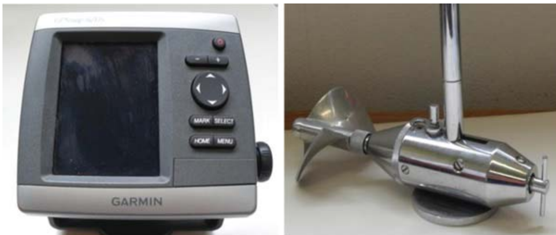
Figura 2. Aparelhos utilizado em campo a) Sonar Garmin para determinação de largura e profundidade; b) Molinete fluviométrico para determinação de velocidade de fluxo,
