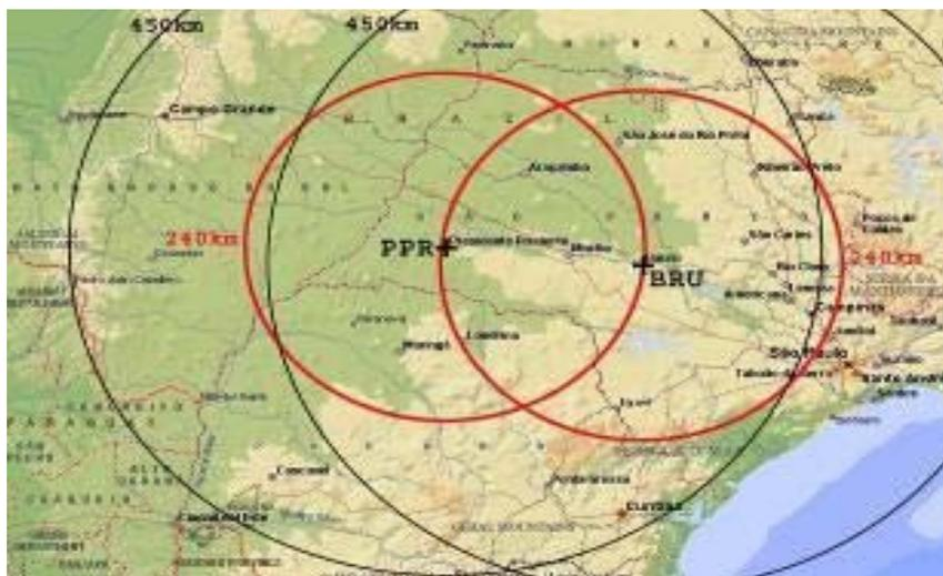
**Figura 1.** Área de abrangência dos radares meteorológicos da UNESP/IPMET. Os círculos vermelhos (menores), correspondem as áreas onde a chuva pode ser quantificadas. Círculos maiores área total de abrangência dos radares.
