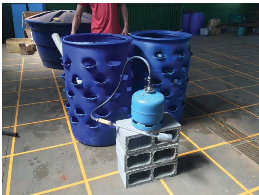
Figura 2. Tambores após processo de abertura dos furos.
