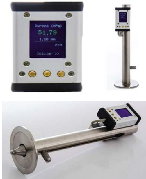
Figura 2. Versão final do durômetro portátil para madeiras – DPM3. a) detalhe do painel eletrônico. b) equipamento na posição vertical. c) visão geral. Fonte: Elaborado pelo autor, 2016
